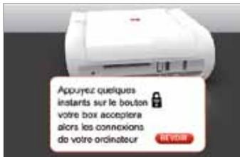
**PC déjà équipé WiFi.** Appuyer sur le bouton représentant un cadenas sur la box et cliquez sur le bouton "OK" dans un délai inférieur à une minute.
