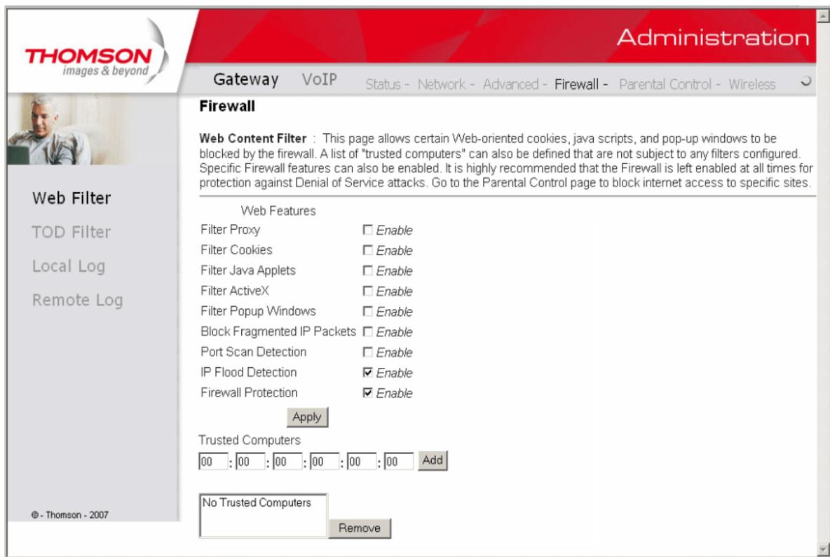
Fig. 27 Gateway\Firewall\Web Filter
